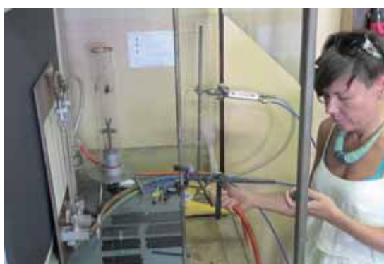
Zdj. 3. Zgaśnięcie próbki, zatrzymanie stopera
