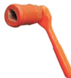
fot. 8. Narzędzie monterskie umożliwiające prawidłowe ułożenie żyły sektorowej w zacisku
