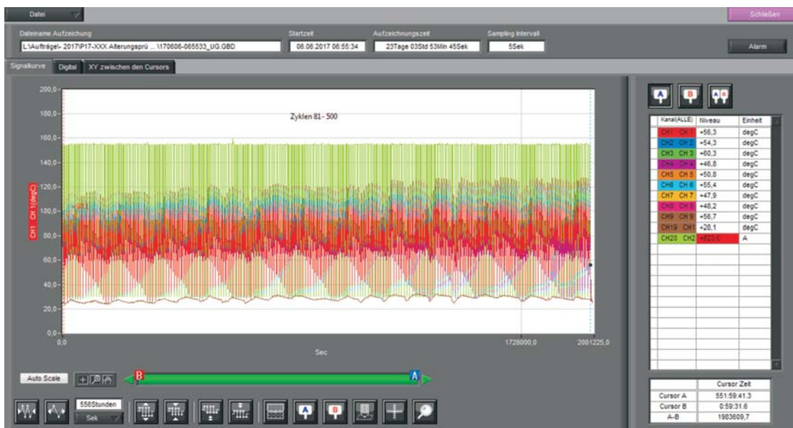
fot. 14. Wykres z wielokanałowego rejestratora temperatury podczas badania trzech rozłączników z zaciskami piętrowymi typu V (z nową przekładką). Cykle od nr 501 do 750.
