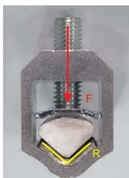
fot. 4. Prawidłowe ułożenie żyły sektorowej w zacisku typu V
