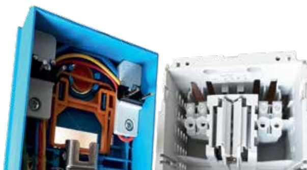
Zdj. 20, 21. Kontrola stanu przepalenia ESF 2 (ESÜ2)
