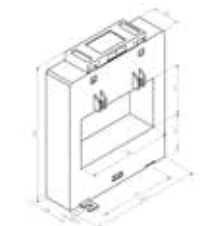
PSA 1274 szyna pierwotna: 4x120x10 mm
