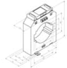
PSA 1034 szyna pierwotna: 2x100x10 mm; 80x50 mm przewód okrągły: \varnothing max 85 mm
