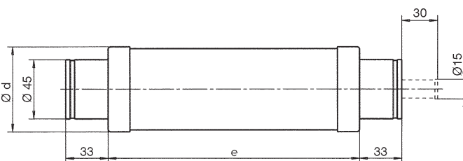
Рис. 2 Типоразмеры согласно DIN 43 625 в мм
